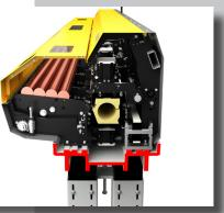
Massives und verwindungssteifes Maschinenbett Grauguss sorgt für optimale Vibrationsdämpfung
