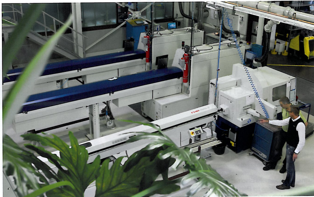
Bild 1: Bei der Meinerzhagener Tebit GmbH sorgt eine produktionsnahe mit modernen CNC-Drehmaschinen von Tornos und Lademagazinen von FMB ausgerüstete Lehrwerkstatt für eine praxisbezogene Ausbildung von Zerspanungsmechanikern
