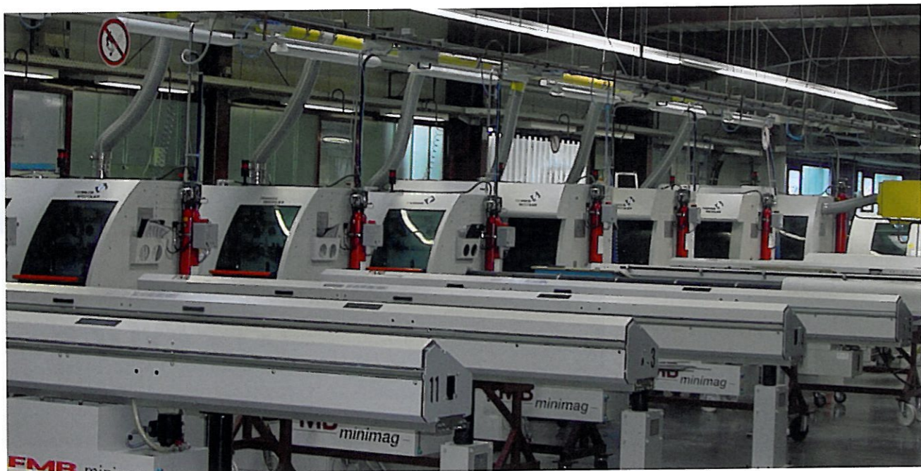
Bild 6: Markentreue als Erfolgsrezept: Gemeinsamer Nenner der 27 Langdrehler und 2 Drehautomaten von Tornos sind bei der Tebit GmbH verschiedene Lademagazine von FMB, mit denen Materialstangen mit Durchmessern von 0,8 mm bis 32 mm vollautomatisch zugeführt werden können (Werkbild: Tebit GmbH, Meinerzhagen)
