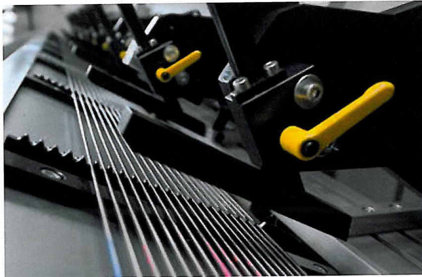
Bild 7: Mit dem micromag 20 offeriert FMB ein Lademagazin, mit dem sich dank Pilgerschrittvereinzelung Materialstangen ab 0,8 mm Durchmesser automatisiert zuführen lassen
