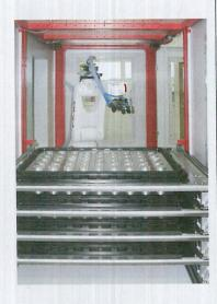
und die Ablage von Fertigteilen fünf Trägerpaletten (Abmessungen 400 x 600 mm). Die Zelle wird vor der Maschine auf einem Schienensystem platziert und lässt sich mit wenigen Handgriffen um 1.000 Millimeter verschieben, wodurch der Zugang zum Arbeitsraum erhalten bleibt.
