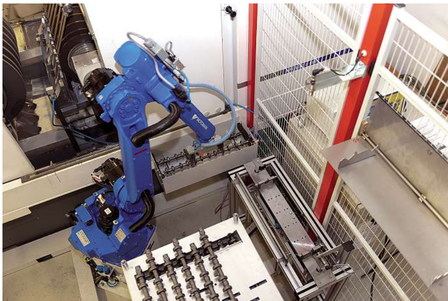
Bild 4: Qualitätssicherung eingebaut: Beide Roboterzellen integrieren präzise, schmutzunanfällige Staudruckmessgeräte.
