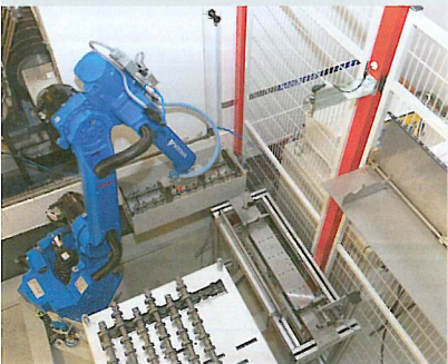
Qualitätssicherung eingebaut: Beide Roboterzellen integrieren hochpräzise, schmutzunanfällige Staudruckmessgeräte von SMB, Fuchstal. Die Firma projiziert und fertigt kundenspezifische Messeinrichtungen vom einfachen Handmessgerät bis hin zur automatisierten Messmaschine.
