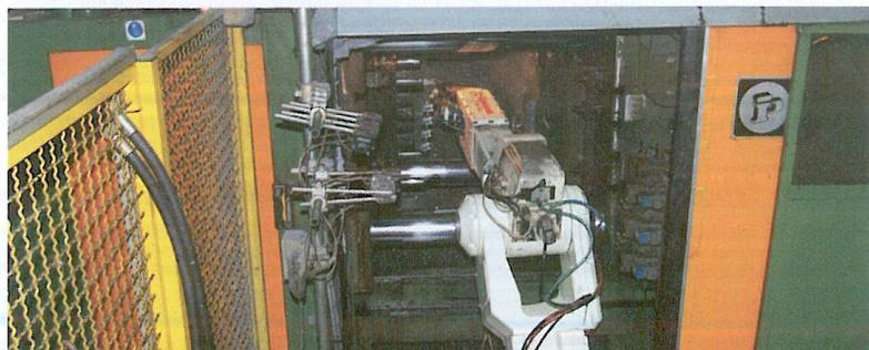
Das Greifen, Wenden und Spannen der dünnen Dichtungsringe erfordert eine spezielle Greiferlösung
