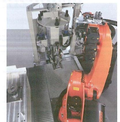
Entgratzelle mit integrierter Bürst- und Frässtation
