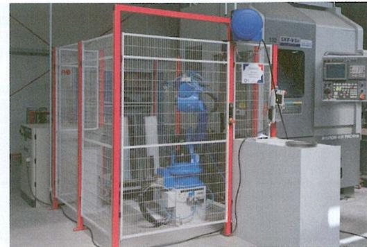
Die Drehzelle ist für die mannlose Komplettbearbeitung von Metalldichtungen mit Dicken von 3 und 4 mm sowie Durchmessern von 70 bis 450 mm ausgelegt. Der Roboter trägt abzüglich Greifergewicht 2 x 8 Kilo schwere Dichtringe
