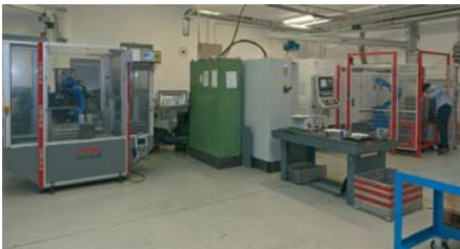
Bild 4: Für den Mehrschichtbetrieb der beiden centerless-Schleifmaschinen braucht es zwar immer noch einen Mitarbeiter je Schicht. Dem bleibt allerdings genug „Luft“ um die bearbeiteten Teile für die Weiterverarbeitung beim Auftraggeber vorzubereiten
