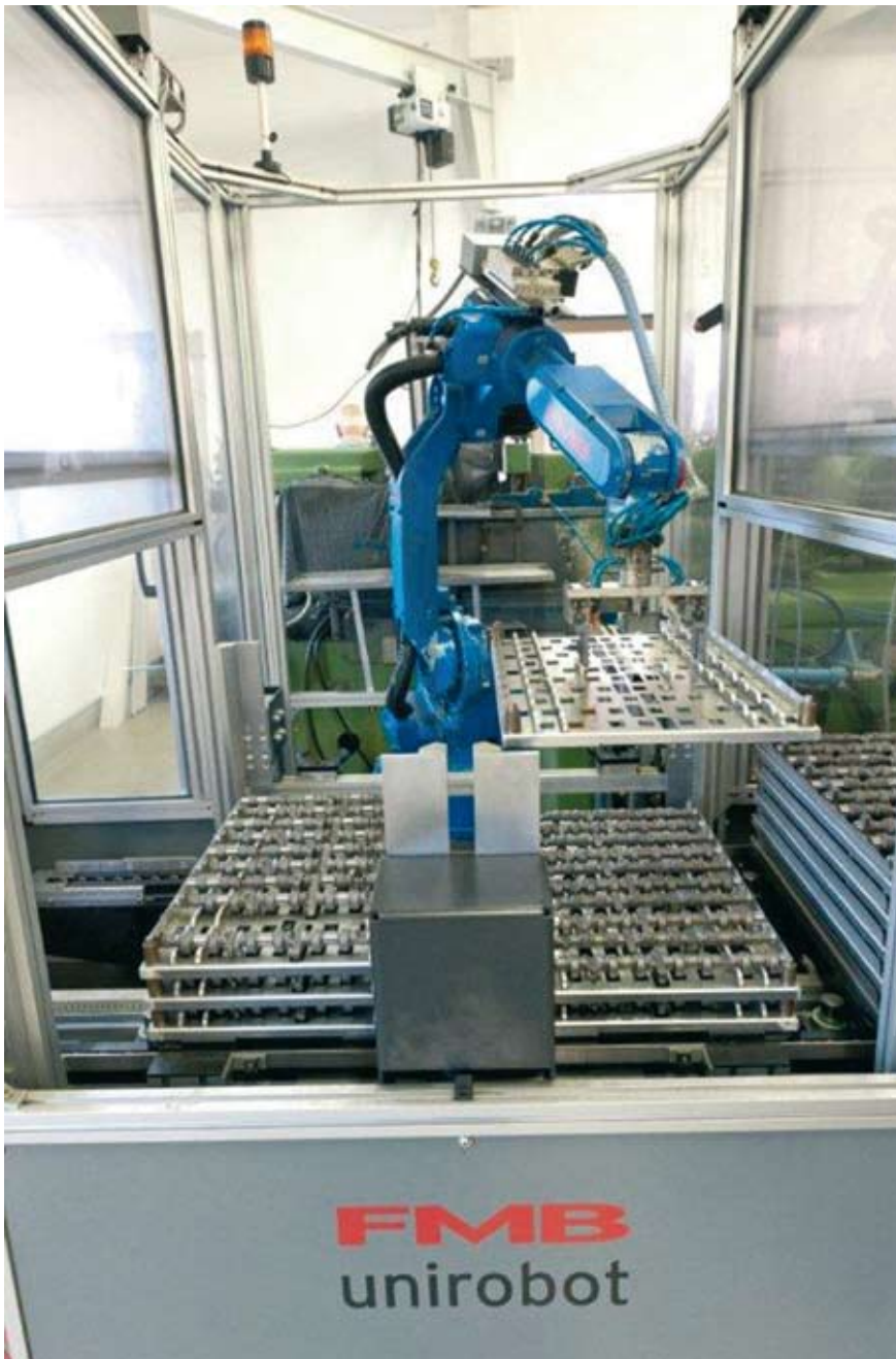
Bild 5: Nach der überzeugenden Automation der 35 Jahre alten Lipköping Anfang 2010 orderte Lerchenmüller auch für die Ende 2010 installierte Mikrosa Kronos L660 bei FMB eine schlüsselfertige Unirobot Automationszelle. Markant sind bei beiden Lösungen die ausgeklügelten Werkstückaufnahme­paletten für die lagefeste Aufnahme von jeweils 10 respektive 8 Exzenterwellen
