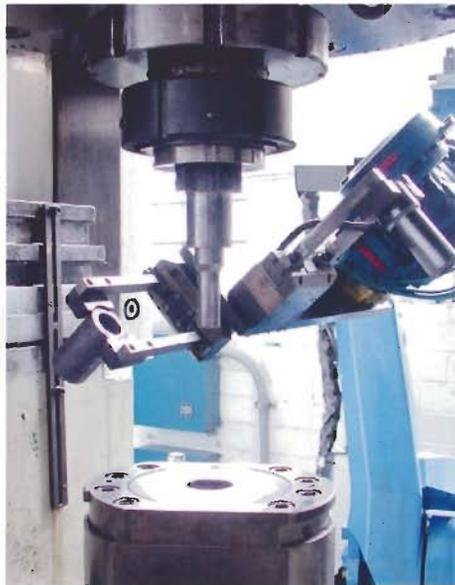
Präzision im Akkord: Mit dem Doppelgreifer wird das Entnehmen und Bestücken »in einem Rutsch« erledigt.
