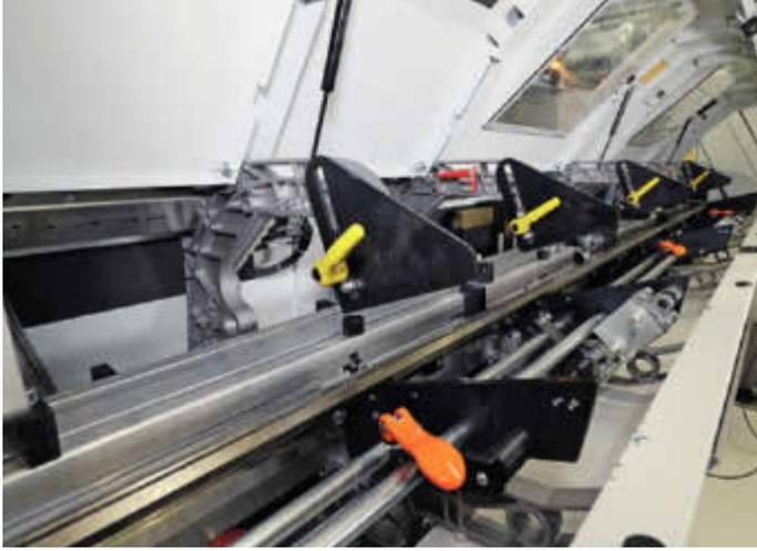
Klemmhebel in Rapsgelb und Exzenterhebel in Reinorange unterstützen die einfache und ergonomische Bedienung des Stangenlademagazins
