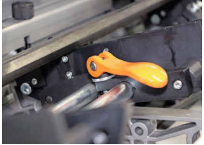
Durch die Formgebung und die angepasste Farbe des Exzenterhebels ließ sich eine gut sichtbare und ergonomische Klemmstelle realisieren
