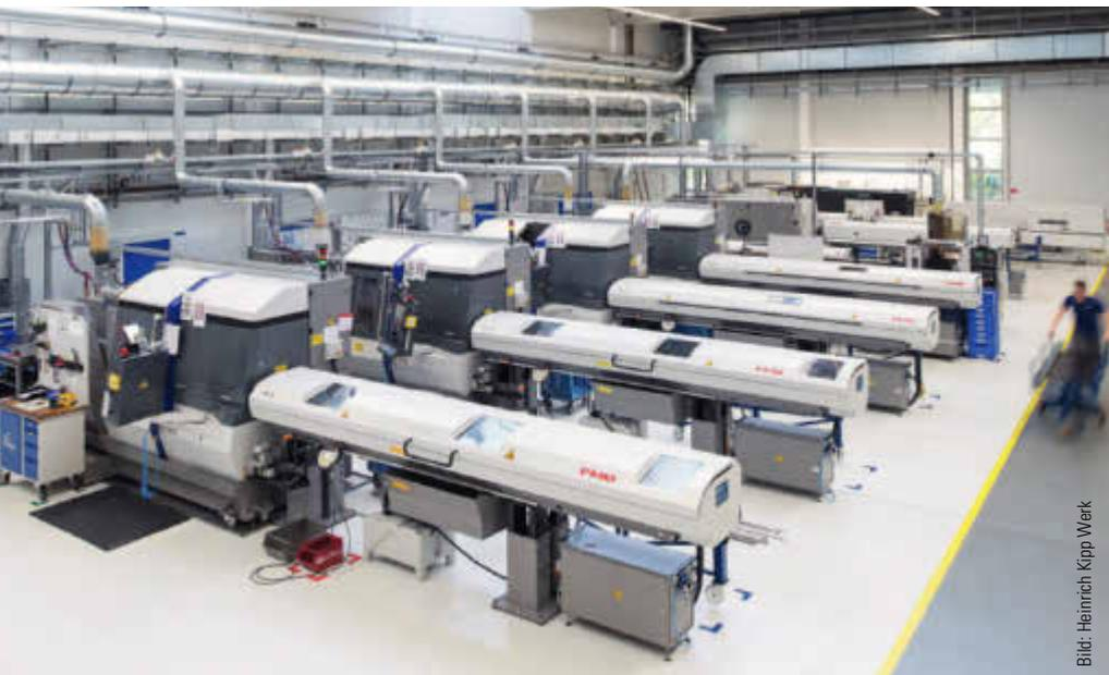
In der Produktion im Heinrich Kipp Werk kommen Stangenlademagazine von FMB zum Einsatz, die mit individuellen Bedienteilen von Kipp ausgerüstet sind
